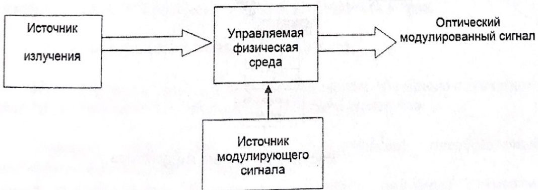
Рисунок 8 - Принцип внешней модуляции
